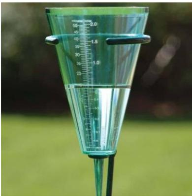
**Pluviómetro:** Mide la precipitación líquida.
