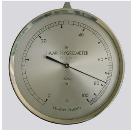
**Higrómetro:** es una herramienta que mide la humedad o el contenido de humedad en el aire.
