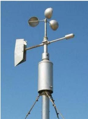
Anemómetro: son dispositivos utilizados para medir vientos como la velocidad y la dirección del viento.
